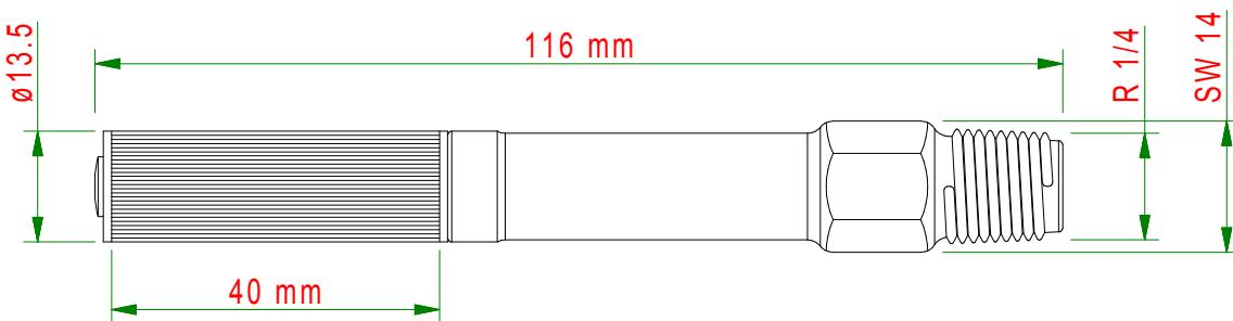
Injektionspacker mit Anschlussgewinde R1/4" für Bohrloch 14 mm.
