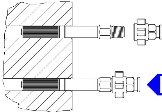
Anschluss: Flachkopfnippel DIN 3404 / 16 mm
